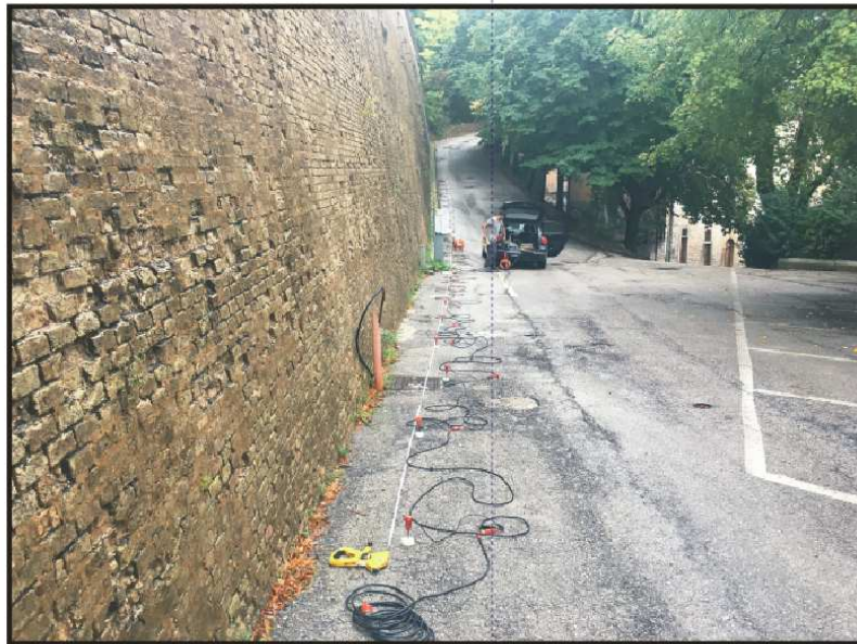
Esecuzione della prospezione geofisica superficiale MASW
