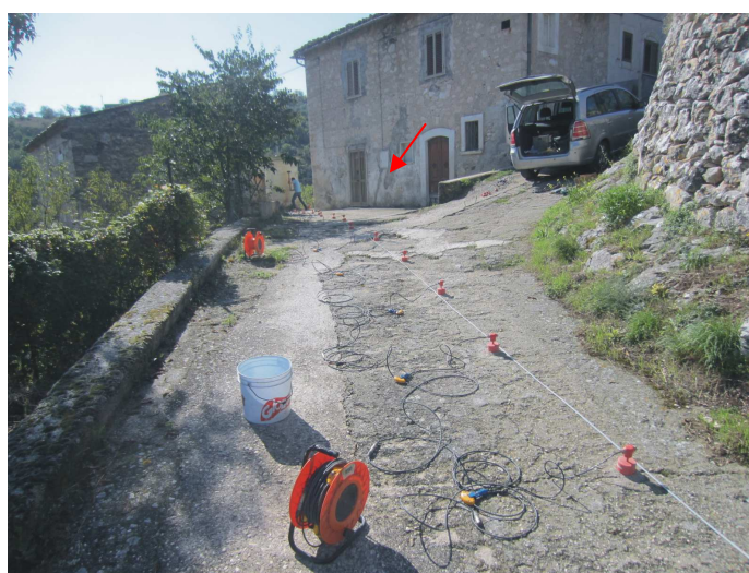
Aggregato edilizio in oggetto – esecuzione prospezione sismica superficiale MASW
