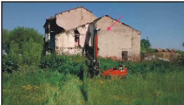
edificio abitativo in oggetto – esecuzione prova penetrometrica CPT 2 – vista da SSW
