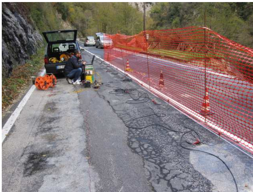
Realizzazione di una prospezione geofisica superficiale in tomografia sismica in onde P eseguita lungo la mezzeria stradale (dicembre 2013)
