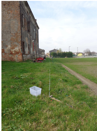
Esecuzione della prospezione geofisica superficiale MASW
