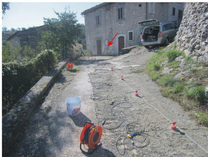
Aggregato edilizio in oggetto – esecuzione prospezione sismica superficiale MASW
