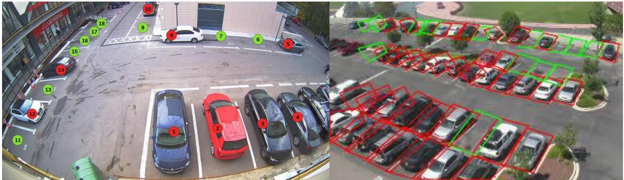
Figura 6-3. Sistemi automatici di riconoscimento degli stalli liberi/occupati (Ph credit: Metrici, Andrew Sobral 16 )
